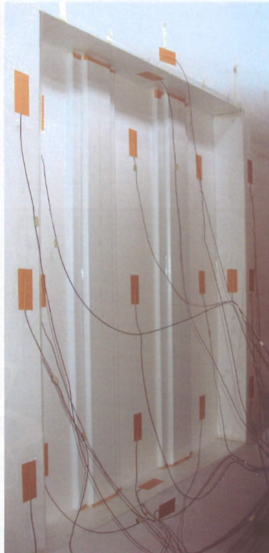
Fotografie del campione durante la prova rispettivamente lato caldo a sinistra e lato freddo a destra.
